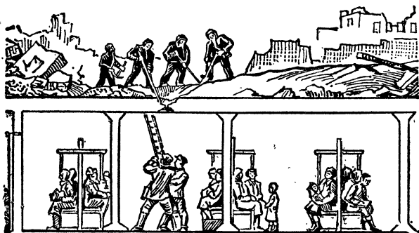
Рис. 37. Пробивание отверстия в перекрытии убежища
